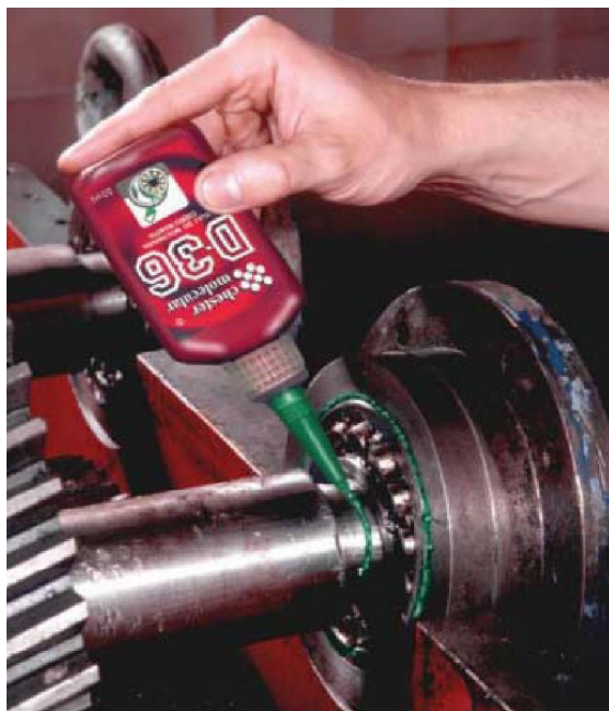
Osadzanie tulei na wale
